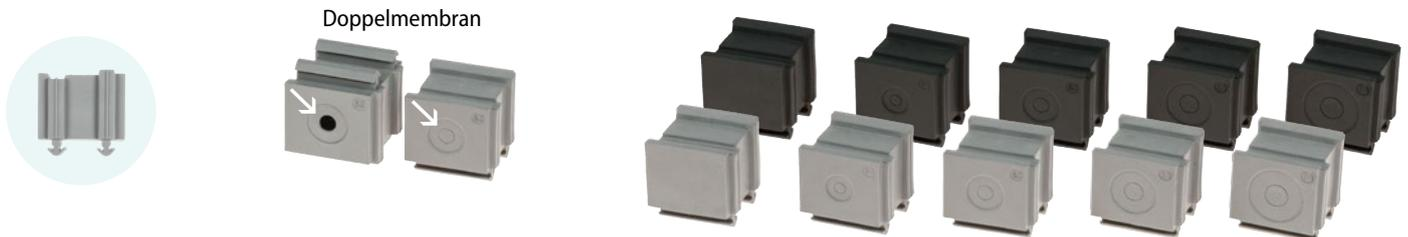
Die SPP K Kabeltülle ermöglicht nicht vorkonfektionierte Kabeln im teilbaren DES Rahmen Platz zu finden. Die Kabeltülle “blind” kann mit Kabeln von einem Durchmesser von 2,5-14 mm durchstochen werden.
